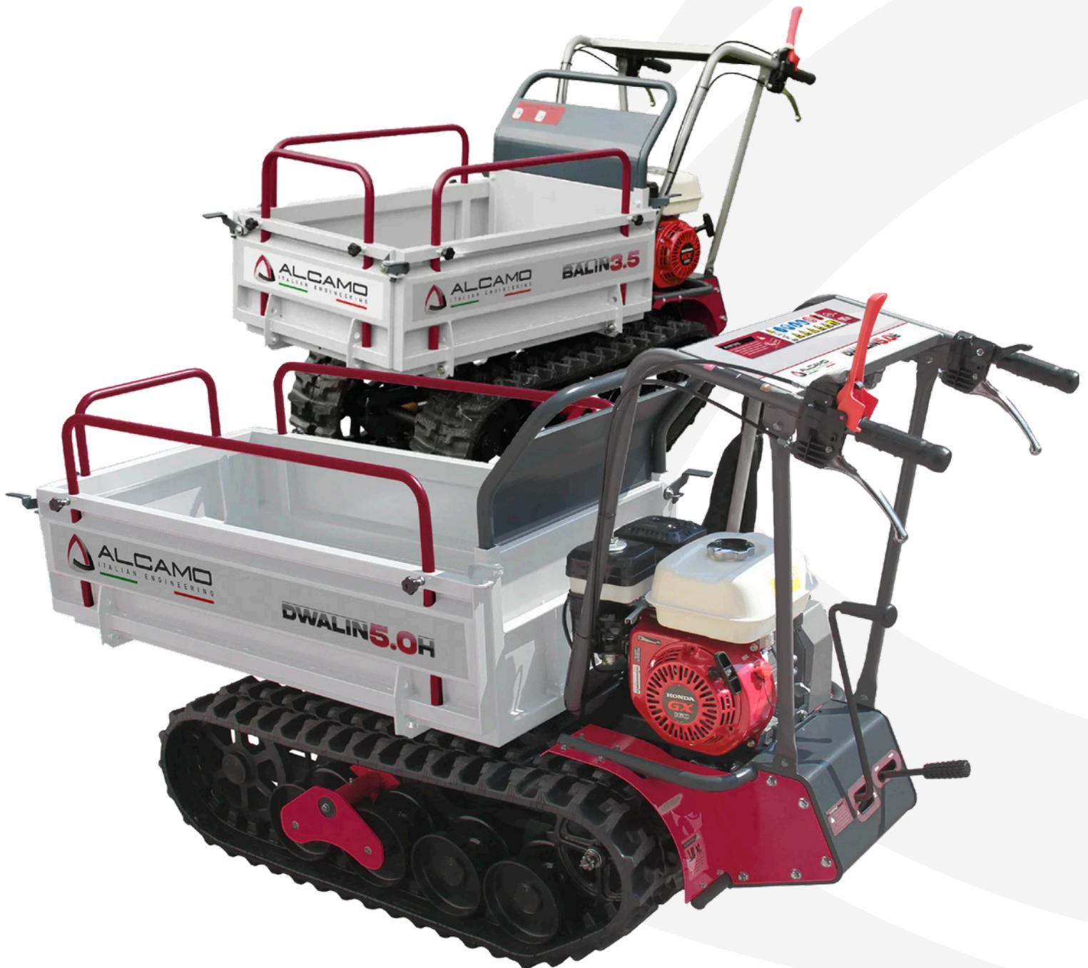
Balin 3.5 e Dwalin 5.0 sono i veri alleati quotidiani, macchine versatili progettate per facilitare il trasporto di carichi o oggetti ingombranti. Da 350 kg a 500 kg a seconda del modello, le motocarriole ti semplificano gli spostamenti, qualunque sia la tua attività: Edilizia, agricoltura, manutenzione del verde, allevamenti, maneggi. Ottimi per il trasporto di qualunque tipo di materiale, sia esso terra, sabbia, legno, macerie o altro.
