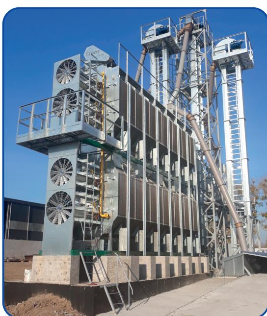
**Особливістю 3-модульної зерносушарки «Agro Star™» з 5 або 6-ти вентиляторами та пальниками є можливість одночасного нагріву та охолодження зерна в сушарці, отримуючи при цьому готовий продукт для подальшого очищення або зберігання.**
