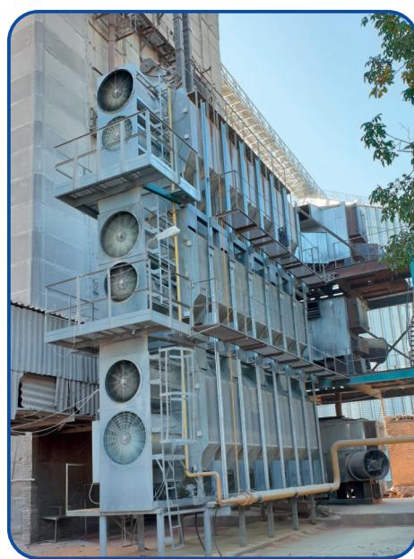
**Зернові сушарки «Agro Star™»** – це сучасне високотехнологічне обладнання, створене в результаті багаторічного досвіду монтажу, експлуатації та обслуговування модульних зерносушарок різних виробників. Конструкція зерносушарки та технологія безперервного сушіння зерна "cross-flow" дозволяє задоволити потреби, як великих зерноприймальних підприємств, так і фермерських господарств, а глибоке розуміння своєї справи нашими фахівцями втілюється у постійному вдосконаленні свого обладнання.
