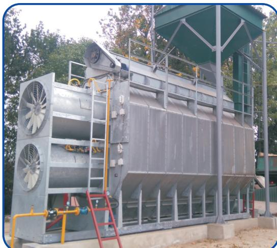
**Особливістю 2-модульної зерносушарки «Agro Star™» з 3-ма або 4-ма вентиляторами та пальниками є можливість одночасного нагріву та охолодження зерна в сушарці, отримуючи при цьому готовий продукт для подальшого очищення або зберігання.**
